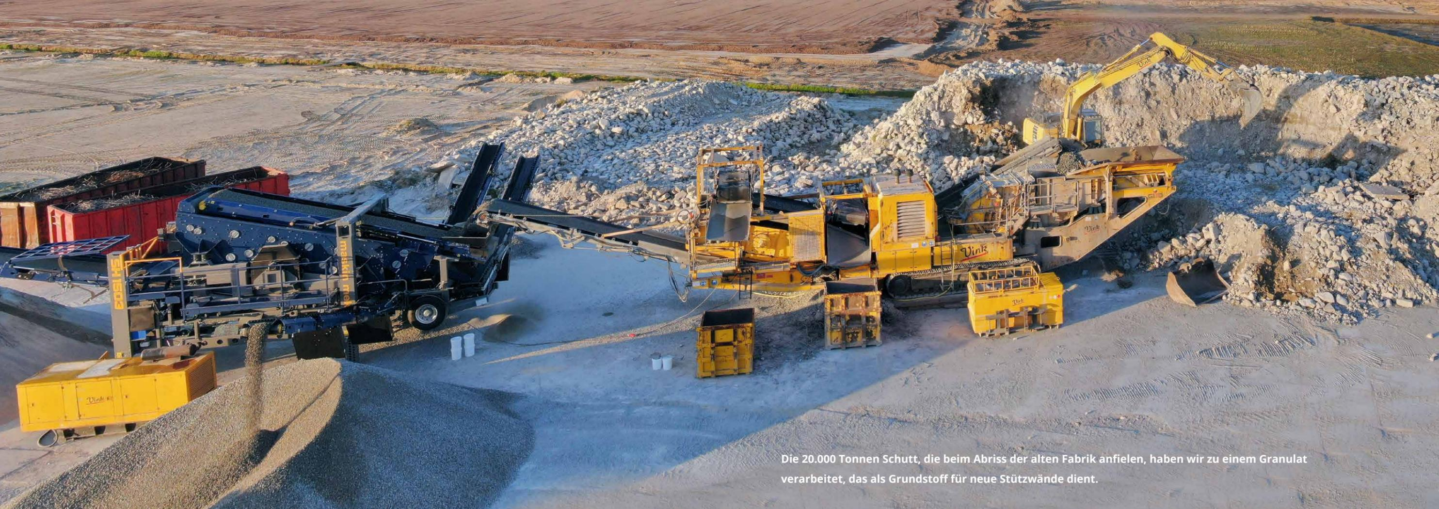
Die 20.000 Tonnen Schutt, die beim Abriss der alten Fabrik anfielen, haben wir zu einem Granulat verarbeitet, das als Grundstoff für neue Stützwände dient.
